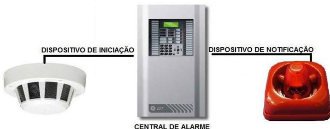
Sistema de detecção e alarme
